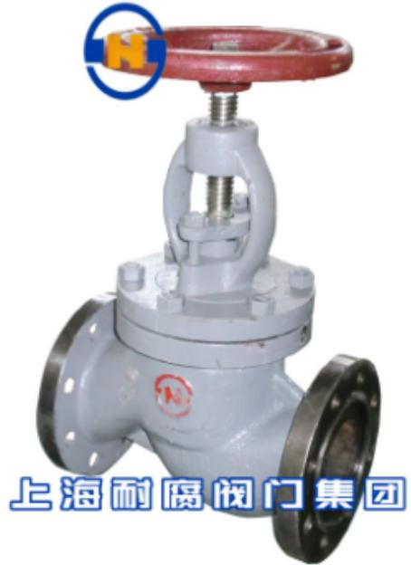
一、J41H/W美标截止阀--概述 J41H/W美标截止阀适用于公称压力PN1.6~16MPa,工作温度-29~550℃的石油、化工、制药、化肥、电力行业等各种工况的管路上，切断或接通管路介质。驱动方式有手动、齿轮传动、电动、气动等。二、J41H/W美标截止阀--结构特点 1、产品的设计制造符合美国国家标准ANSI B16.34,美国BS1873等国外先进标准要求。2、阀体外形为桶形或流线型造型美观。流通形状为直通式。流体阻力小。3、关闭件（闸瓣）与阀座密封面采用锥面密封，关闭力小，耐冲刷，密封可靠。4、阀座可为更换式阀座，可任意组合与关闭密封面材料的配对，以满足工况的要求，延长使用寿命。5、大口径、高压力截止阀根据关闭力的需要阀杆的传动方式采用升降杆，并配有滚动轴承式采用撞击式手轮以减轻关闭力。6、主体材料、内件材料、填料、紧固件的材料可按用户要求或实际工况条件合理组合。
